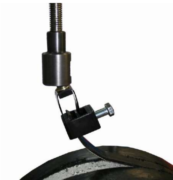
Рисунок 2 – Крепление образца в приборе ПСИ-МГ4
